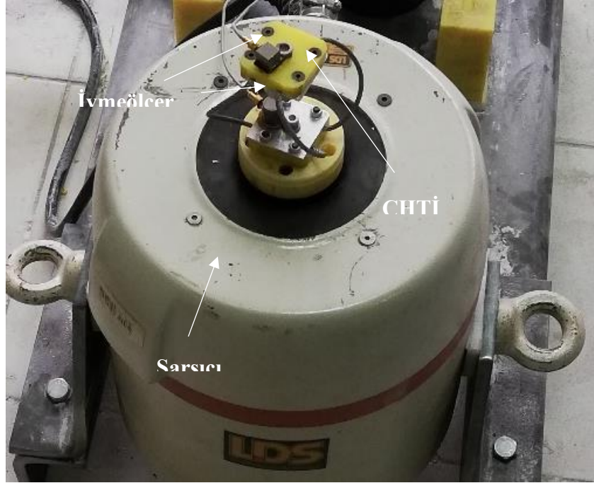
Şekil 3.12. Sarsıcı, ÇHTİ ve ivmeölçer
