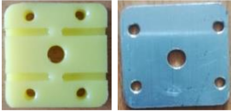
Şekil 2.6. Fikstür ve alüminyum tasarlanmış parça
