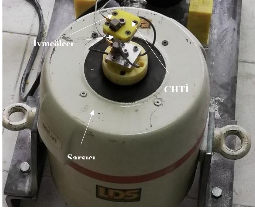
Şekil 3.12. Sarsıcı, ÇHTİ ve ivmeölçer
