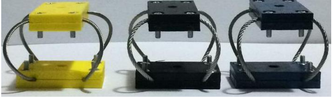
Şekil 2.15. ÇHTİ montajlanmış hali sırasıyla 7x7-1x19-7x19
