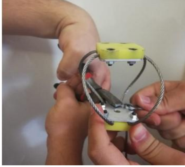
Şekil 2.10. Telleri S şeklinde burarak montajlama
