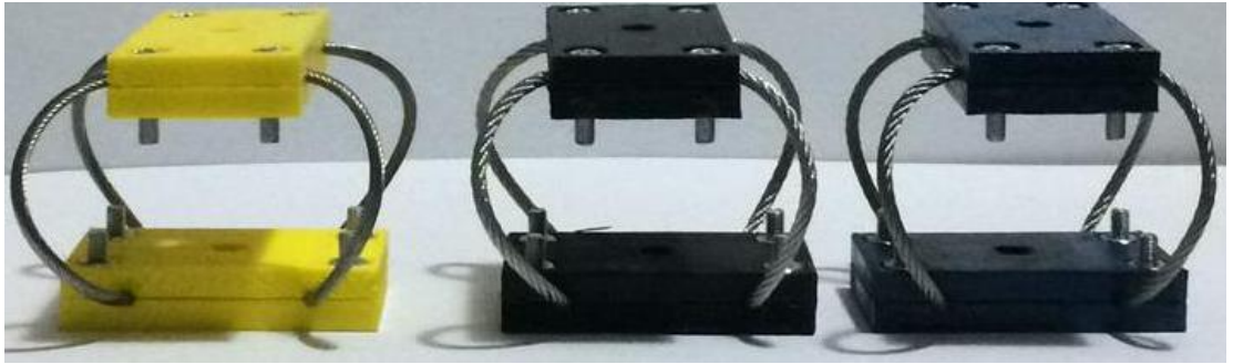
Şekil 2.14. ÇHTİ montajlanmış hali sırasıyla 7x7-1x19-7x19
